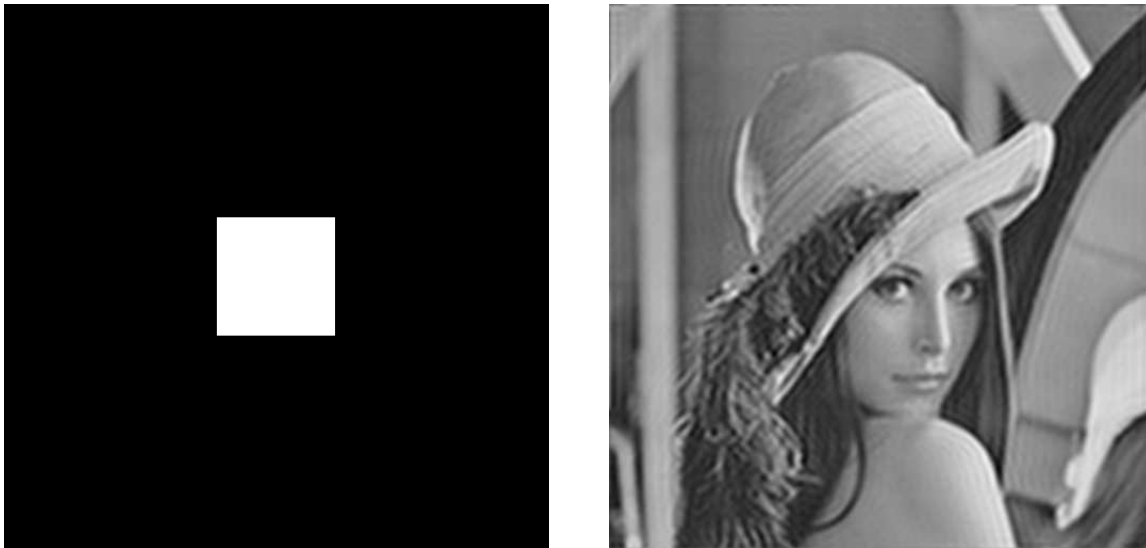
Fig. 3.3. Maska filtru dolnoprzepustowego, i przekształcona Lena. Stopień kompresji wynosi ok. 21 (obraz po prawej ma w rezultacie ok. 0,38 bita na piksel (bpp))
