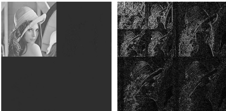
Rysunek 6.19: Transformata falkowa głębokości 1 i głębokości 9 (silnie rozjaśniona)
