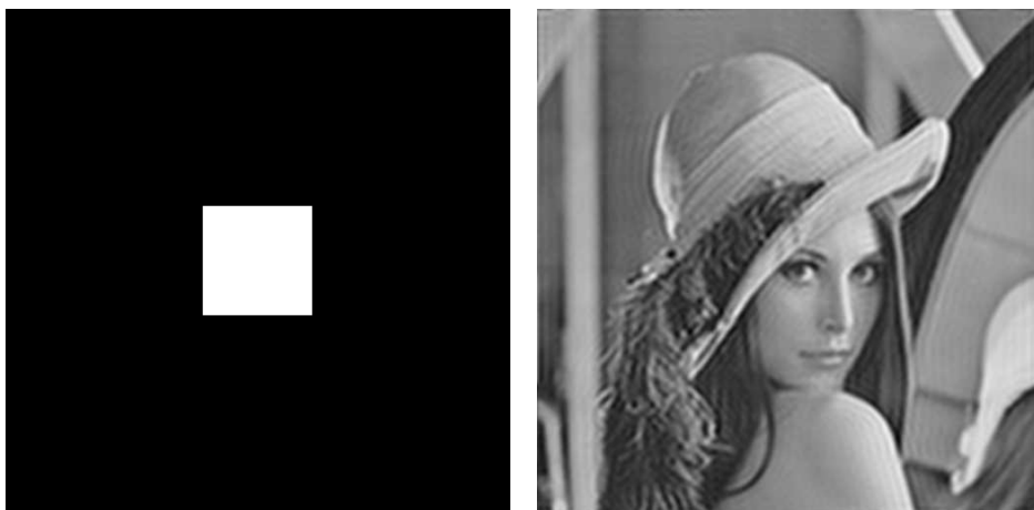
Rysunek 6.18: Maska filtru dolnoprzepustowego, i przekształcona Lena. Stopień kompresji. wynosi ok. 21 (obraz po prawej ma w rezultacie ok. 0,38 bita na piksel (bpp))
