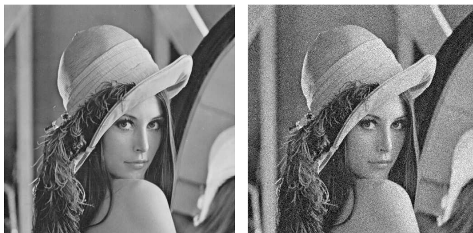
Rysunek 8.9: Zaszumienie obrazka, \sigma^2 = 20 .
