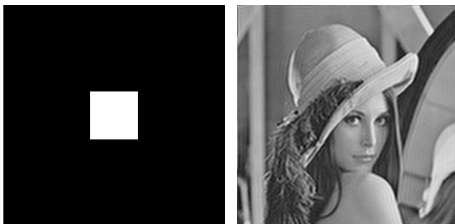
Rysunek 8.18: Maska filtru dolnoprzepustowego, i przekształcona Lena. Stopień kompresji. wynosi ok. 21 (obraz po prawej ma w rezultacie ok. 0,38 bita na piksel (bpp))
