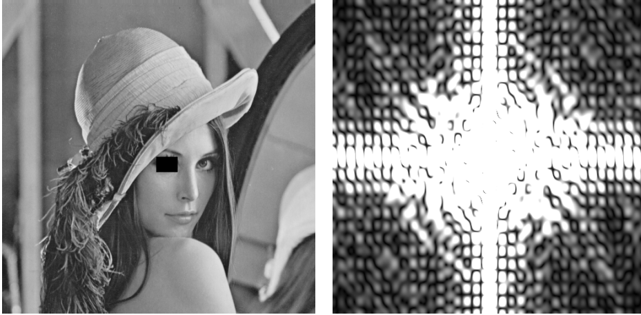
Rysunek 8.17: Lena z niewielką modyfikacją (prawe oko). Obok moduł różnicy transformaty Fouriera Leny zwykłej i zmodyfikowanej.
