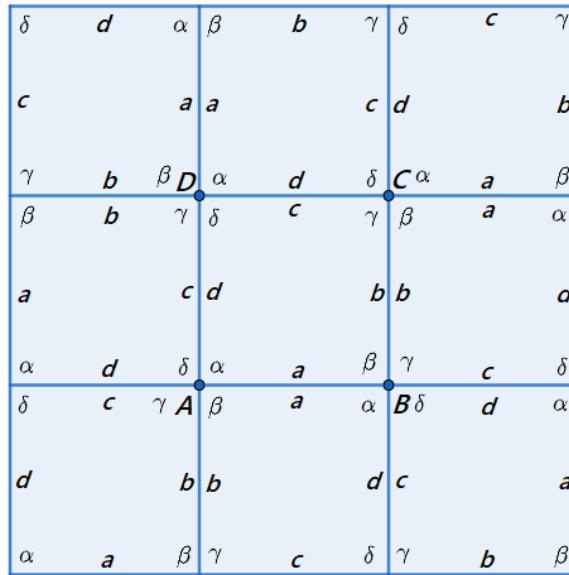
Rysunek 45: Analiza kształtu płytki w parkiecie typu IH53
